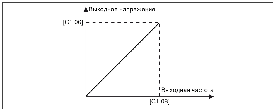
Рис. 12-62: Линейная кривая V/F
