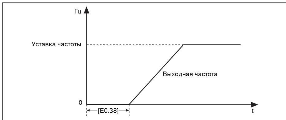
Рис. 12-29: Торможение пост. током перед запуском
