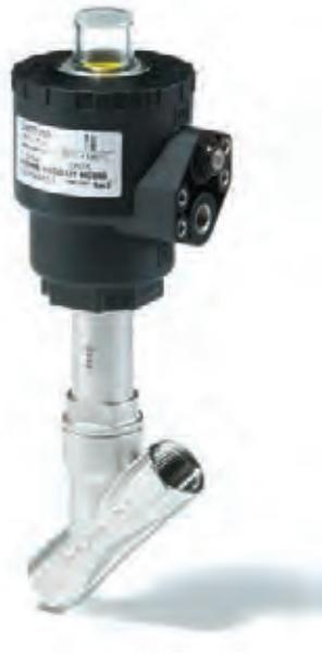
AV210 — угловые пневматические клапаны, предназначенные для использования в жестких промышленных условиях. Клапан может работать при очень высоких температурах и значениях вязкости рабочей среды и нечувствителен к частицам грязи, содержащимся в этой среде. Клапаны выпускаются с корпусом из бронзы (RG5/бронза) или нержавеющей стали (AISI316).
