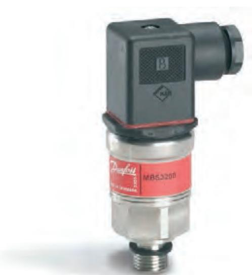
Компактный высокотемпературный датчик давления MBS 3200, предназначенный для использования в различных отраслях промышленности, обеспечивает надежное измерение давления даже в жестких условиях окружающей среды. Широкая номенклатура преобразователей предусматривает выходные сигналы 4 – 20 mA, 0 – 5 В, 1 – 5 В, 1 – 6 В и 0 – 10 В, измерение абсолютного и избыточного давления, диапазоны измерения от 0 – 1 до 0 – 600 бар, а также использование самых разнообразных штуцеров и электрических штекеров.
