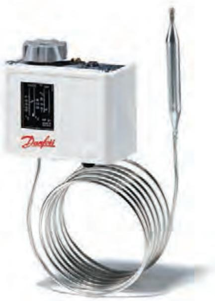
Реле температуры KP производства компании Danfoss используются для систем регулирования, контроля и аварийной сигнализации в промышленных установках. Реле температуры KP — это автоматические реле, положение контактов которого зависит от температуры контролируемой среды. Эти устройства снабжены однополюсным переключателем на два направления (SPDT) и могут непосредственно управлять работой однофазных двигателей переменного тока мощностью до 2 кВт.
