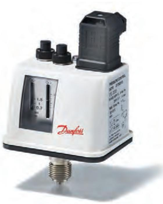
Серия BCP предназначена для автоматизации и технологической защиты паровых и водогрейных котлов. Реле давления оснащено однополюсным перекидным контактом, который меняет положение в зависимости от соотношения давления среды и уставки. В случае ответственных применений рекомендуется использовать реле с функцией защиты.
