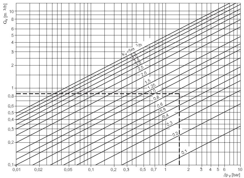
Соотношение между расходом воды и перепадом давления на клапане.
