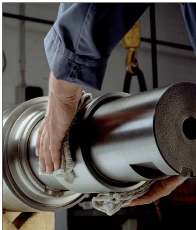
71. Ручная установка меньшего по размеру внутреннего кольца цилиндрического роликоподшипника
