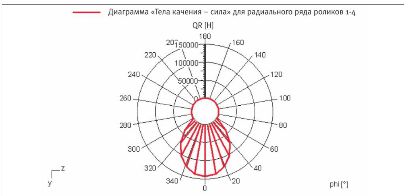
28b. Распределение нагрузки в четырехрядном цилиндрическом роликоподшипнике на опорном валке
