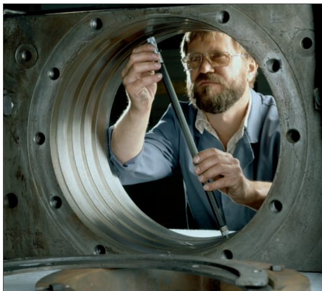
66. Отверстие крупногабаритной подушки измеряется внутренним микрометром
