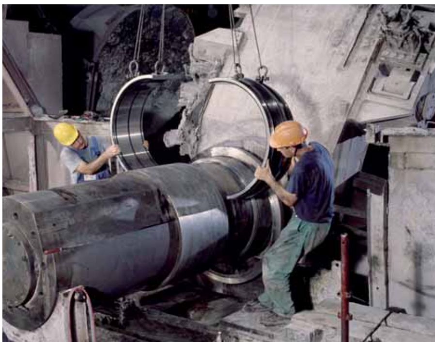
Монтаж крупногабаритного разъемного сферического роликоподшипника
