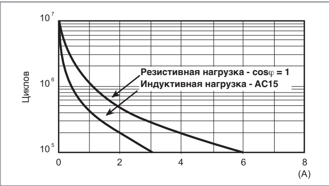
F 7S12 - Электрическая долговечность (AC) при ном. нагрузке - 7S.12
