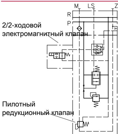
Соединительный блок для систем с нерегулируемым насосом со встроенным 3-ходовым регулятором потока и предохранительным клапаном
