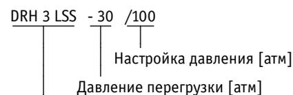
Основной тип, размер объекта, принцип действия: Двойной невозвратно-управляемый клапан (тип DRH), размер 1 - 5
