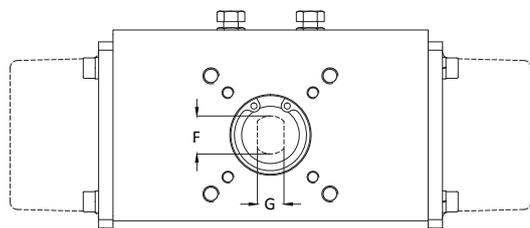
Подсоединение зубчатого вала F89U размеры 004-240
