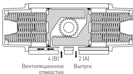
Выходной вал с двумя шпонками позволяет осуществить монтаж параллельно или перпендикулярно направлению потока клапана. В обычных условиях привод устанавливается параллельно направлению потока клапана, поворачиваясь против часовой стрелки из закрытого в открытое положение.
