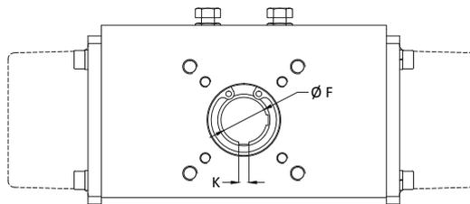
Привод F89 имеется с 4 различными присоединениями клапана: F89D - ISO 5211 (метрическая резьба); F89E - Keystone ISO (метрическая резьба); F89U - Keystone дюймовая + метрическая резьба
