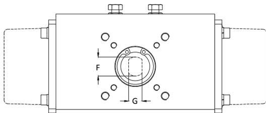
Подсоединение зубчатого вала F89E размеры 032-240
