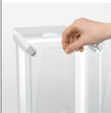
Ветрозащитный кожух QuickLock демонтируется за несколько секунд без каких-либо инструментов. Гладкие и закругленные поверхности облегчают очистку.
