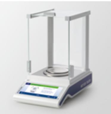
Встроенная функция LevelControl сигнализирует, если весы не выставлены по уровню, и выводит на дисплей инструкции, которые помогают выровнять весы за несколько секунд.
