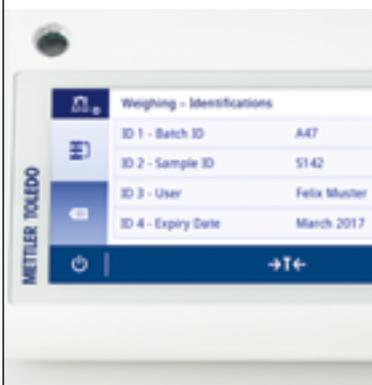
Возможность ввода до 4 идентификаторов образца (ID пользователя, ID образца, ID партии и т.д.) с помощью встроенной сенсорной панели или сканера штрих-кода гарантирует полную прослеживаемость.
