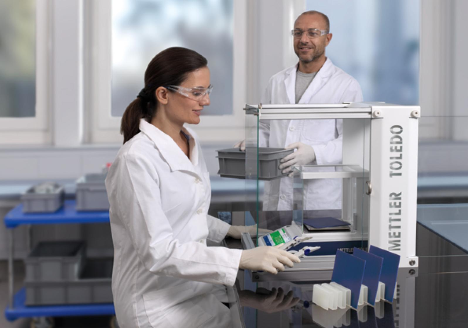
Большой кожух защищает весы от потоков воздуха, что идеально подходит для выполнения тонких операций, таких как определение веса покрытий методом дифференциального взвешивания.
