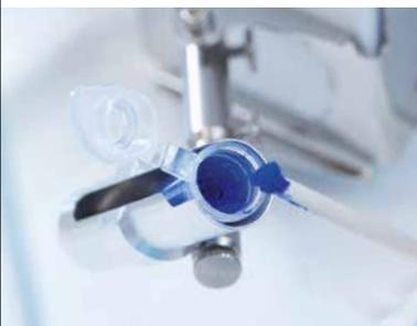
**Приспособления ErgoClips и решетчатая чашка SmartGrid ускоряют процесс взвешивания**
