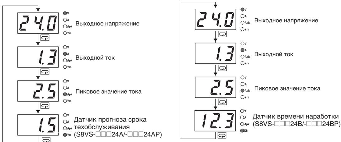
**Примечание.** При первом включении источника питания после получения его с завода будет отображаться выходное напряжение. Впоследствии выходное напряжение будет отображаться на том же индикаторе при выключении.
