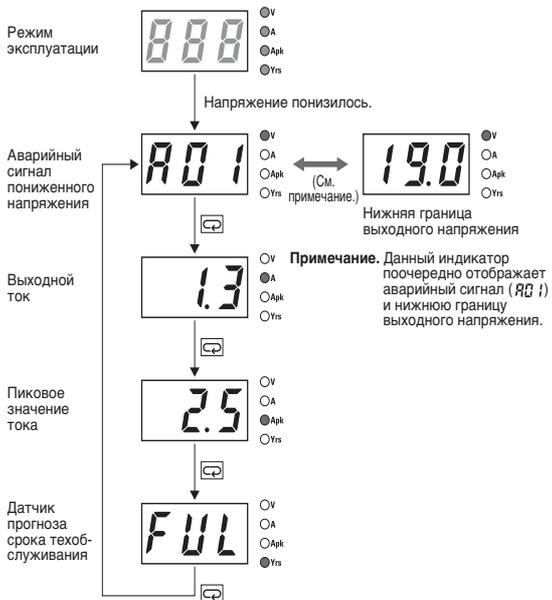
**Примечание.** Индикатор переключается на отображение напряжения после восстановления напряжения до установленного или более высокого значения.
