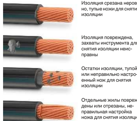
Ошибки снятия изоляции согласно DIN МЭК 60352-2
