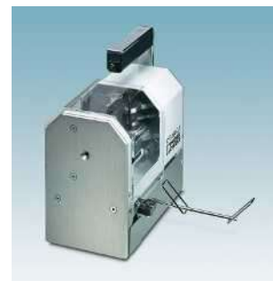
Автоматы для снятия изоляции и обжима для кабельных наконечников CF 3000... Стр. 516 CF 1000... Стр. 518
