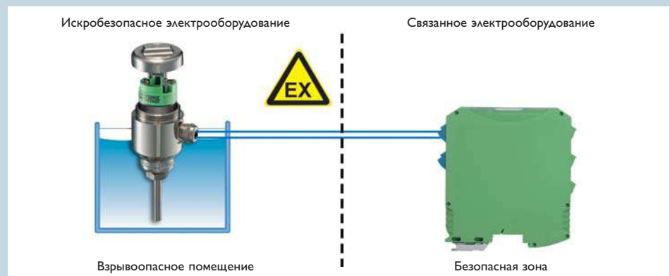
Пример: Совместное включение электрооборудования при виде взрывозащиты «Искробезопасность»
