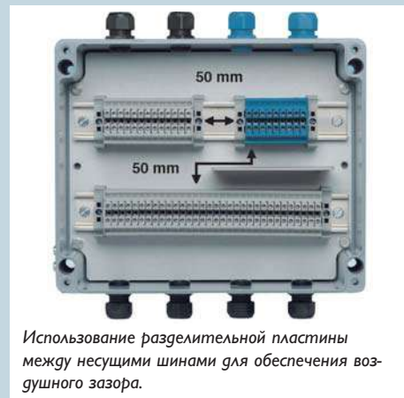
Необходимую величину воздушного зазора между искробезопасными и другими электрическими цепями следует соблюдать и в случае использования нескольких несущих шин.
