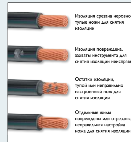
Ошибки снятия изоляции по DIN МЭК 60352
