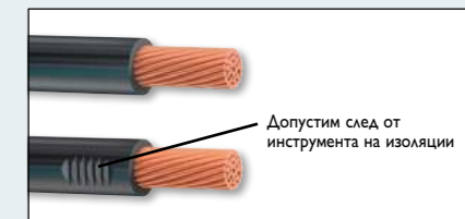
Провод с безупречно снятой изоляцией по DIN МЭК 60352
