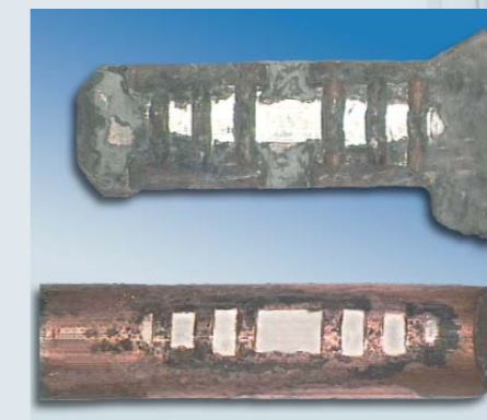
Зоны контактов винтовой клеммы после проведения теста
