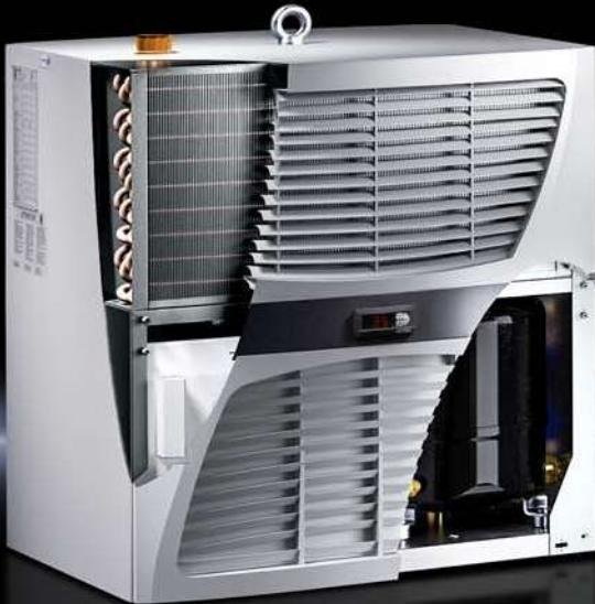
Чиллеры используются для охлаждения жидких сред и обеспечивают высокую точность поддержания температуры. Выполненный в виде открытой системы водяной контур имеет встроенный буферный накопитель, в который поступает отводимая нагретая вода, охлаждаемая затем до установленной температуры. Благодаря модульной конструкции, дисплей с управлением для микроконтроллера может быть размещен с передней или с задней стороны.
