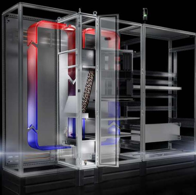
Воздухо-водяной теплообменник в системе шкафов TS 8, подходит для шкафов TS 8 глубиной 600 или 800 мм и высотой 2000 мм. Разделение системы охлаждения и шкафа предотвращает попадание воды в шкаф и повышает удобство монтажа и сервисного обслуживания. Промышленный LCP помещается в лифт и проходит сквозь двери. Благодаря малому весу поверхностная нагрузка небольшая.
