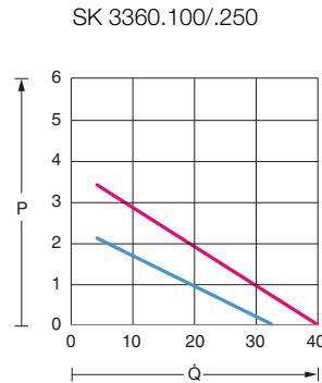
Класс мощности 8 – 40 кВт, 50 Гц при  $T_u = 32^\circ\text{C}$
