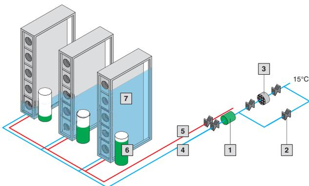
При подключении без гидравлической балансировки LCP по-разному снабжаются холодной водой. LCP, которые наиболее удалены от циркуляционного насоса и имеют наибольшее гидравлическое сопротивление, не получают достаточного объема воды для охлаждения.
