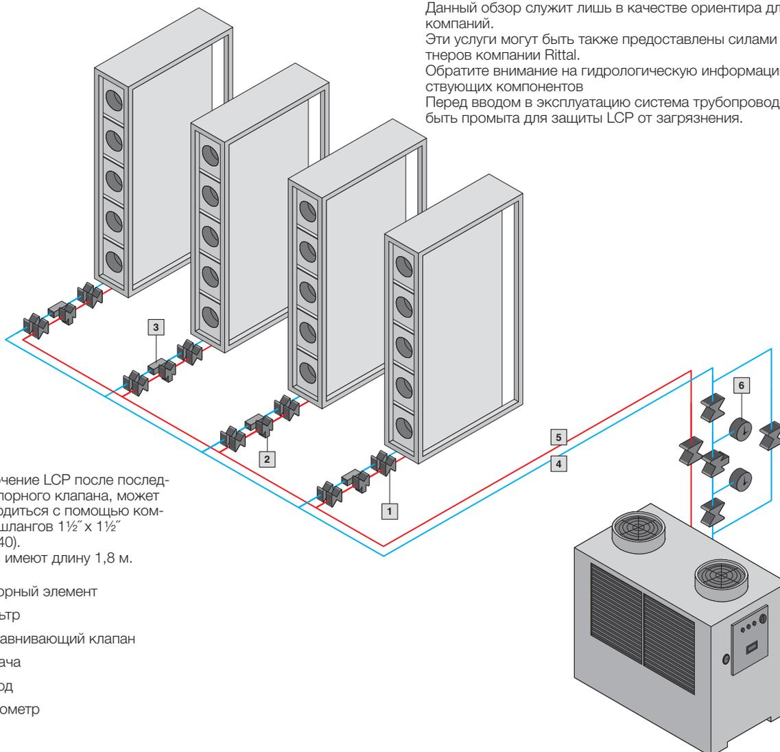
Подключение LCP после последнего запорного клапана, может производиться с помощью комплекта шлангов 1½" x 1½" (3311.040). Шланги имеют длину 1,8 м.
