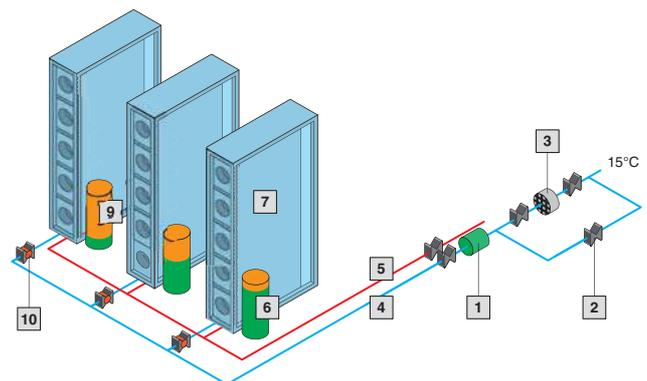
При гидравлической балансировке падения давления выравниваются с помощью регулировочных устройств в сети трубопроводов. Все LCP обеспечиваются равным количеством воды.
