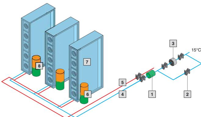
Подключение по принципу Тихельмана соответствует гидравлической балансировке. Все трубопроводы имеют одинаковое падение давления.
