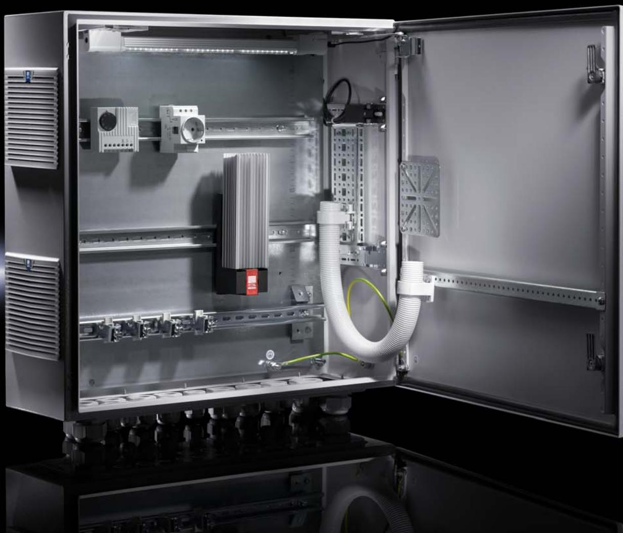
Для предотвращения образования конденсата в шкафах и для достижения минимальной рабочей температуры (например, в случае отключения установки на ночь) используются обогреватели распределительных шкафов.
