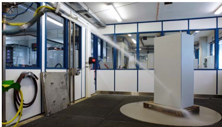
Испытание на IP в лаборатории Rittal
