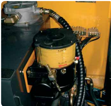
Насосный узел со встроенной управляющей электроникой на машине KOMATSU PC110.
