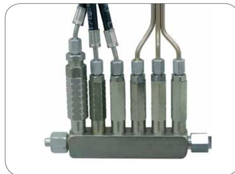
В-дозаторы SKF обеспечивают индивидуально выбранную дозировку 20–500 мм<sup>3</sup> на каждую точку смазывания
