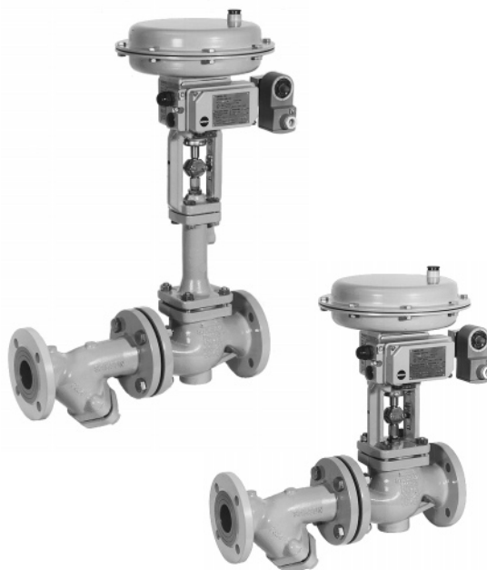
Тип 241-1 Тип 241-газ с сильфонной частью и тип 241-масло, оба с позиционером, магнитным клапаном и грязеуловителем
