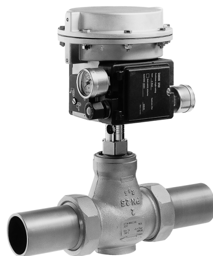
Рис. 2 Пневматический регулирующий клапан типа 3222/2780-2 с проходным клапаном типа 3222 и пневматическим приводом типа 2780-2 и позиционером типа 3760
