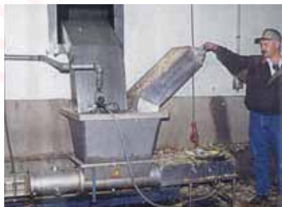
Насос seepex BTM 35-6, продукт: куры и отходы кур, вязкость: < 50.000 сП, давление: 3 бар, производительность: 5 м 3 /ч
