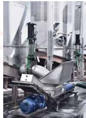
Насос seerex BT 130-6L , продукт: виноградное сусло, давление: 3 бар, производительность: 80 м 3 /ч
