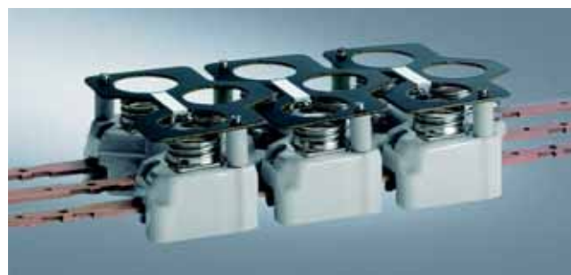
Трехфазные навесные цоколи предохранителей DIAZED DII для 3 x 25 А, 5SF2 07 с исполнением зажимов „B“ установлены на 3 сборные шины EZR 5SH3 54. Каждую из сборных шин можно нагружать до 150 А.
