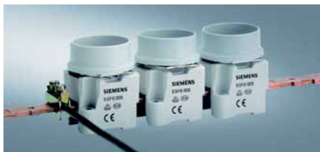
Навесные цоколи предохранителей DIAZED DII для 25 А, 5SF6 005 с исполнением зажимов „B“ установлены на сборную шину EZR 5SH3 54. Подводящие провода закреплены при помощи навесного зажима 8JH4 122. Сборную шину можно нагружать до 150 А.
