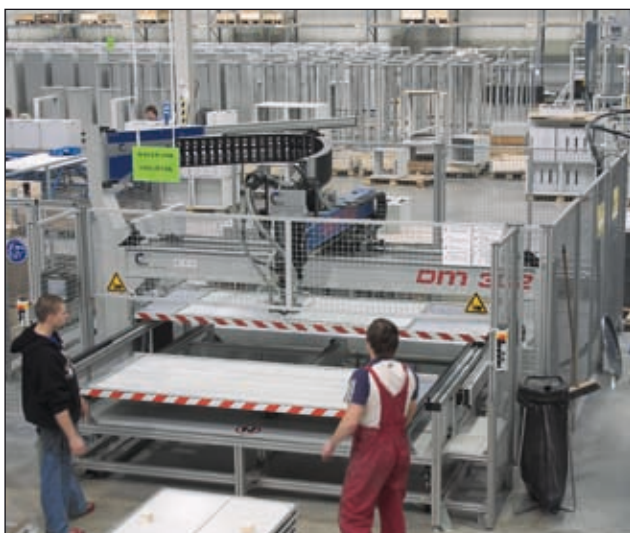
Станок по заливке герметизирующего уплотнителя
