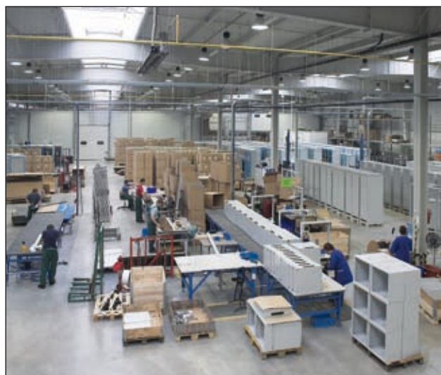
Монтаж телекоммуникационных шкафов
