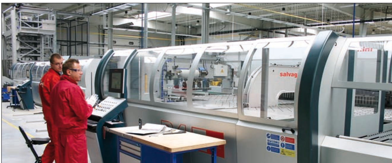
Автоматическая штамповочно-загибающая линия для обработки жести
