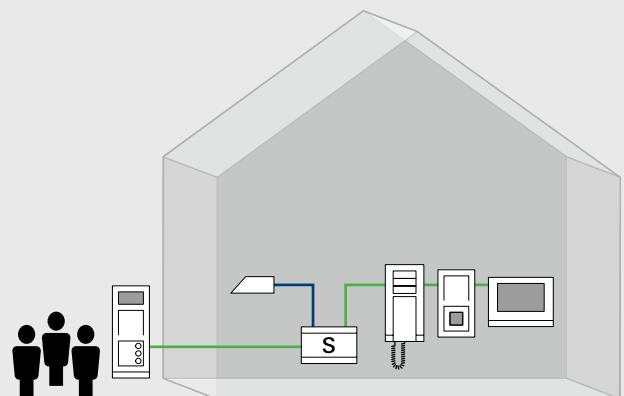
Комбинированная аудио-/видеодомофонная система для одноквартирных домов. На чертеже изображена используемая в системах всех типов и простая в установке 2-проводная шина. Она соединяет видео-вызывную станцию ABB-Welcome и системный контроллер ABB-Welcome. Далее она проходит к ABB-WelcomeTouch, а также к внутреннему устройству абонента, аудио ABB-Welcome с дисплеем и внутреннему устройству абонента, аудио ABB-Welcome с трубкой. В использовании дополнительных распределителей нет необходимости.
