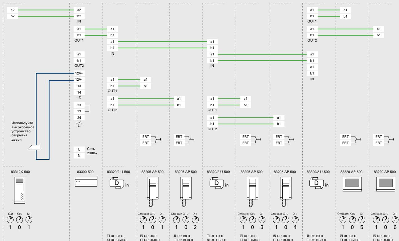
Тип системы: аудио-видеодомофонная система с двумя дверными блоками; разводка кабелей: внутри здания используются две линии внутренней шины.
