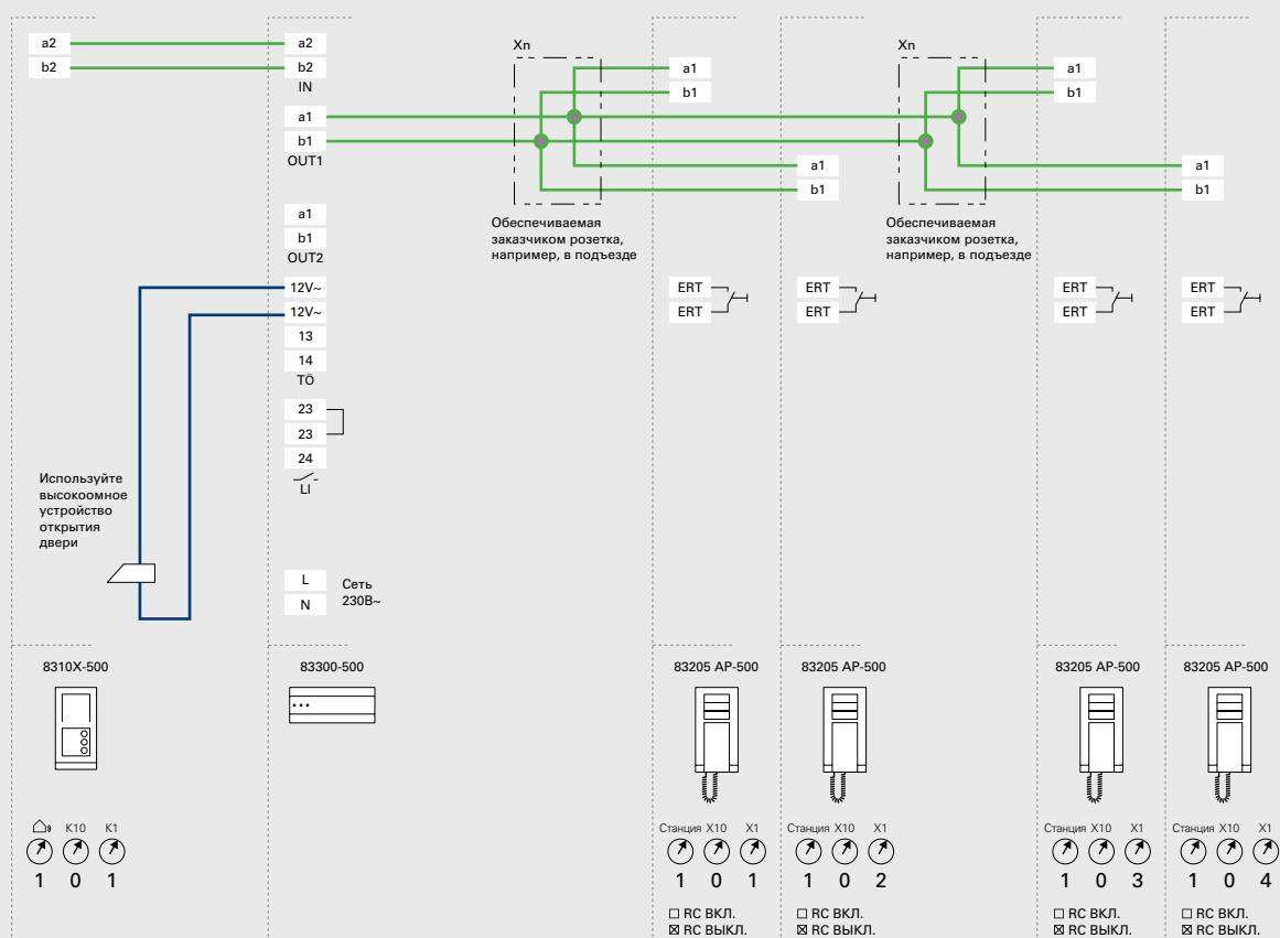
Тип системы: аудио-видеодомофонная система; разводка кабелей: стояк с ответвлениями/видеораспределителями
