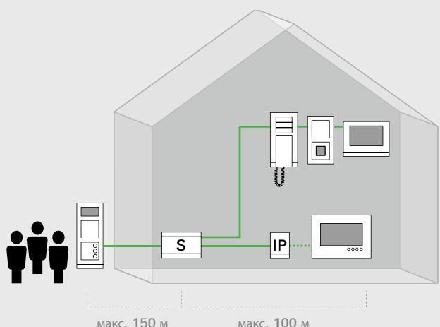
**Многоквартирный дом на 15 квартир, в каждой квартире: абонентское устройство ABB-Welcome с трубкой**
