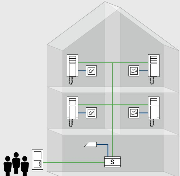
Аудиодомофонная система для многоквартирного дома. На чертеже изображена используемая в системах всех типов и простая в установке 2-проводная шина. Она соединяет аудио-вызывную станцию ABB-Welcome с системным контроллером ABB-Welcome. Далее она проходит к абонентским устройствам, аудио ABB-Welcome с трубкой. В использовании дополнительных распределителей нет необходимости.
