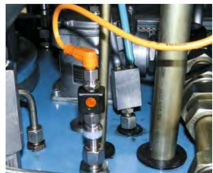
Применение модульного преобразователя TP вместо первичного преобразователя / и преобразователя на DIN-рейку.
