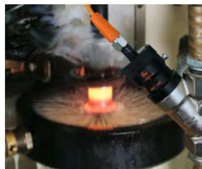
Мехатронный датчик потока в контуре охлаждения индукционной электропечи.
