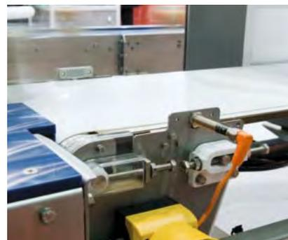
Безопасное обнаружение перемещаемых деталей на конвейерной ленте.
