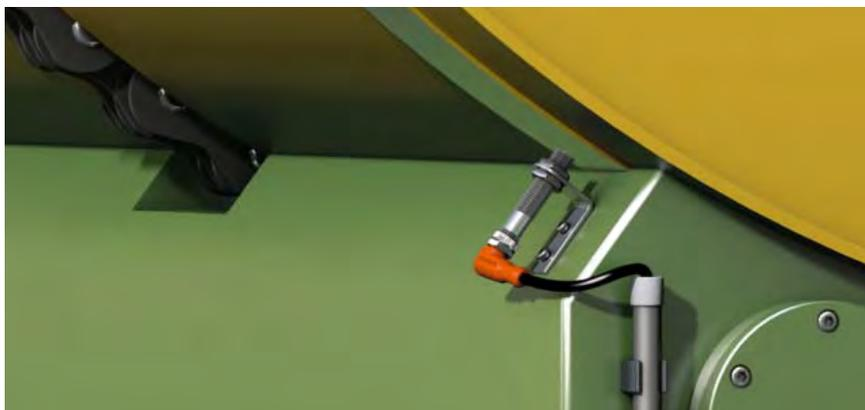
**Размещение опрокидывателя с помощью индуктивных датчиков**
