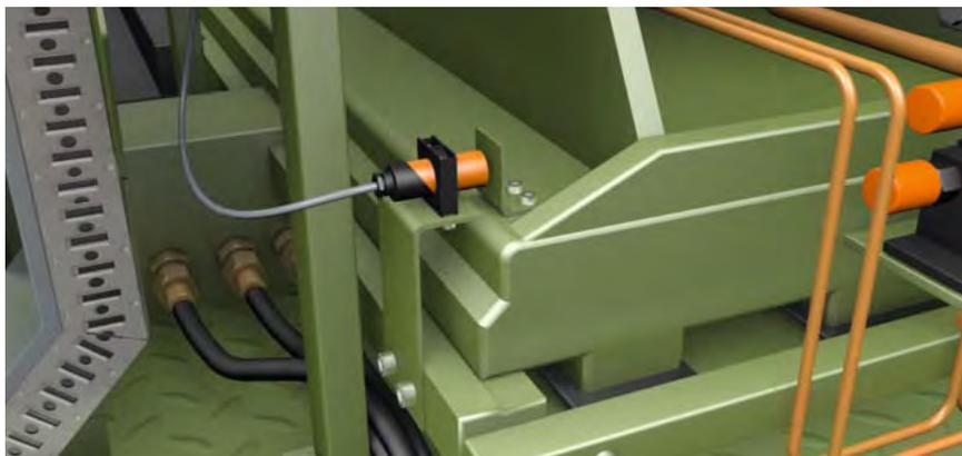
**Контроль конечного положения роликового конвейера**
