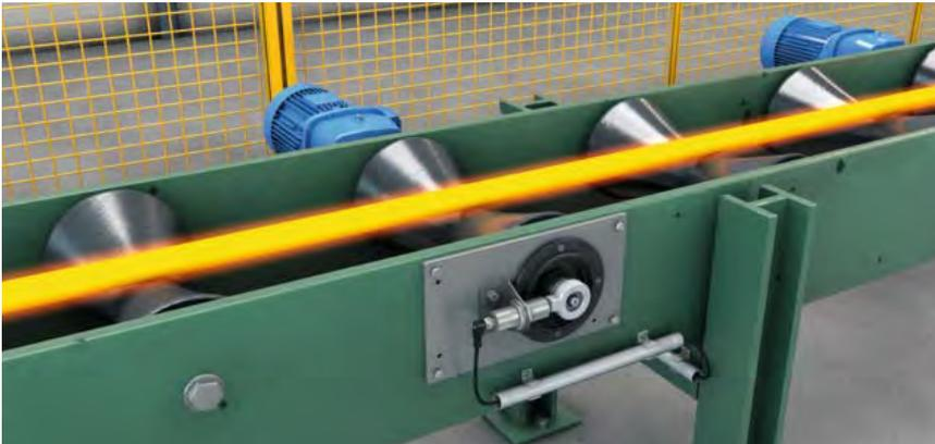
**Контроль роликового конвейера**
