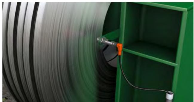
**Оптические датчики OG в цилиндрическом корпусе, M18**
