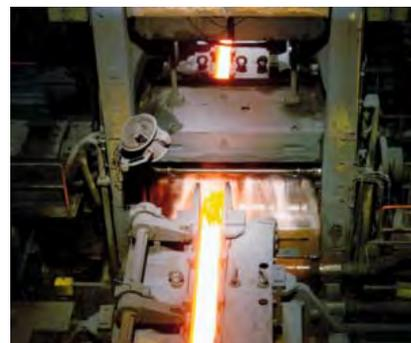
Во время формовки рельсов температура должна точно контролироваться.
