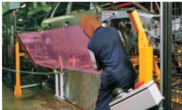
Защита станции сварки: вертикальная зона защиты, оснащенная световой завесой фирмы SICK, с уклоном вперед. Это устройство одновременно обеспечивает защиту кистей рук и защиту от доступа сзади
