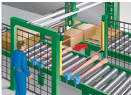
Защита доступа с функцией «muting» в упаковочных и транспортных системах
