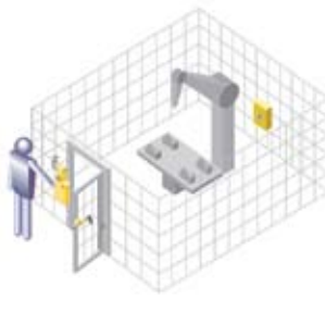
Ключ извлечен, машина переходит в режим ожидания, дверь может быть открыта
