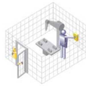
Оператор внутри зоны, ключ вставлен во внутренний защитный блок, машина работает (модель «право доступа»)
