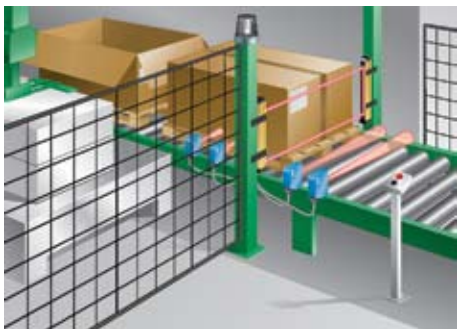
Защита доступа с функцией «muting» в упаковочных и транспортных системах
