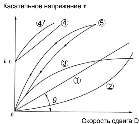
Диаграмма 3. Ньютоновские и неньютоновские среды (Hiroshi Matsuyama, Jitsuyo Kogyo Bunseki, 61, Syoenergy Center, 2001)
