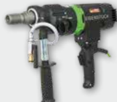
PowerLine PLD 182 2.300 W; 0-520/-1.250/-2.700 min -1 ; Ø 12-182 mm
