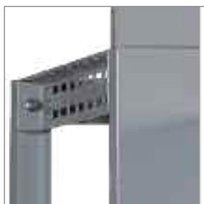
Использование на вертикальных стойках и вертикальных уголках отбортовок, предотвращающих осевое вращение боковых стяжек, позволяет применять вдвое меньше, по сравнению с предыдущей конструкцией, количество элементов крепления для сборки.
