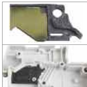
Дополнительная защита от прогорания корпуса автоматического выключателя и отвод тепла за счет пластиковой и металлической антипрогарных пластин.
