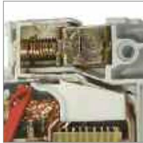
Напайка из серебросодержащего композита повышает износостойкость контактной группы и снижает переходное сопротивление. Обеспечивает повышенную износостойкость выключателя.
