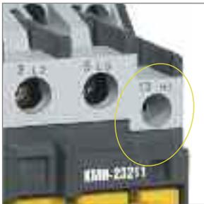
Наличие встроенных дополнительных контактов. Каждый контактор до 32 А комплектуется одним встроенным дополнительным контактом: 1з или 1р (закрывающий или размыкающий). Контактors от 40 до 95 А комплектуются двумя дополнительными контактами: 1з + 1р.
