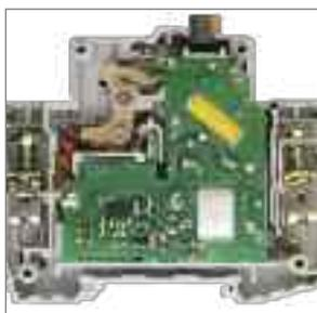
Комбинированная схема с электронным модулем дифференциальной защиты, варистором класса D и встроенным выключателем серии ВА47-60 обеспечивает 4 вида защиты: от дифференциального тока (тока утечки); короткого замыкания; перегрузки; а также защиту внутренних частей устройства от импульсных перенапряжений.
