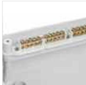
Съемный держатель шин N и РЕ можно устанавливать как вверху, так и внизу корпуса на специальные крепления. Сами же шины N и РЕ устанавливаются на съемный держатель простым защелкиванием в посадочные места.
