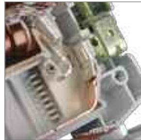
Напайка из серебросодержащего композита повышает износостойкость контактной группы и снижает переходное сопротивление.
