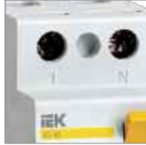
На корпус нанесена маркировка клеммных зажимов, что позволяет избежать ошибок при монтаже. Опломбировка винтов, соединяющих корпус, позволяет избежать несанкционированного разбора аппарата.
