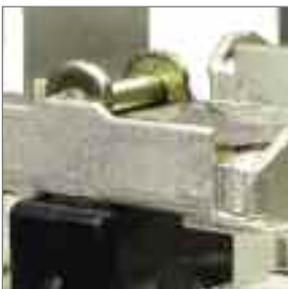
На контакт-детали нанесено серебряное покрытие, позволяющее использовать контакторы в продолжительном режиме работы. Напайки на контакт-детали выполнены из композитов на основе серебра, что позволяет уменьшить контактное сопротивление при повышении температуры.
