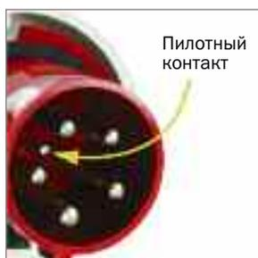
Разъемы на токи 63 и 125 А оснащены «пилотным» контактом, который включается после того, как другие контакты вилки соединены, а при отключении именно он размыкается первым. Пилотный контакт располагается в центре контактного круга 4 или 5 — контактного разъема.
