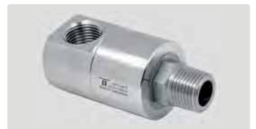
DGEI 90°. Gehäuse Edelstahl. 3-fach gelagert. Max. 350 bar
