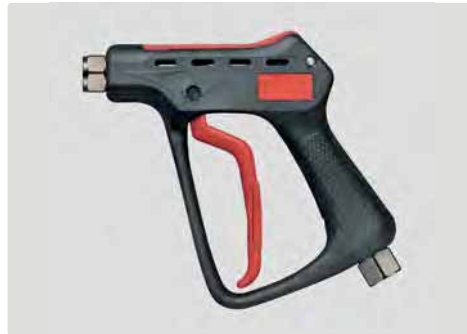
Professionelle Höchstdruckpistole. Max. 600 bar / 80 l/min / 150 °C
