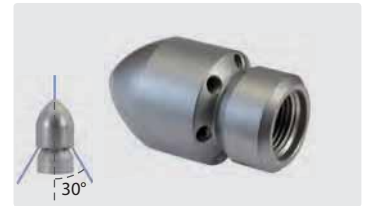
3/8" IG. Außen \varnothing 30 mm. 6 Bohrungen hinten, 1 Bohrung vorn
