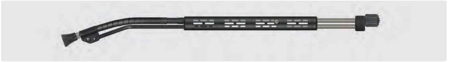
HV M22 drehbar. ST-85 Push & Pull Lanze mit Düsenschutz ST-10 ohne Hochdruckdüse. Max. 210 bar / 150 °C
