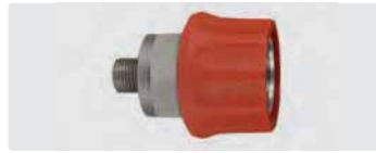
Kupplung : AG. Edelstahl. Max. 600 bar / 150 °C
