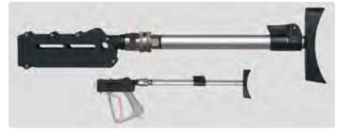
ST-3900 Schulterstützen. Neue EU-Richtlinien schreiben den Gebrauch von Schulterstützen bei Arbeiten mit einer Rückstoßkraft von mehr als 150 N zwingend vor. Stufenlos verstellbare Schulterstütze. Drehbare Kupplung. Geeignet für alle Pistolen ST-3600 / ST-3500.
