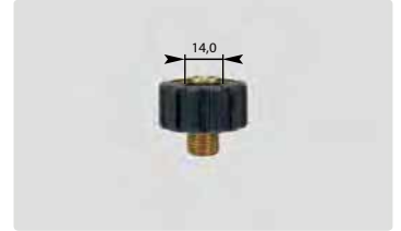
Kurz M22 : AG. Schwarz. Max. 400 bar / 150 °C
