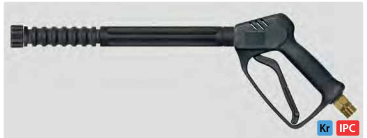
Professionelle Pistole mit Verlängerung 340 mm und HV M22. Max. 210 bar / 25 l/min / 150 °C
