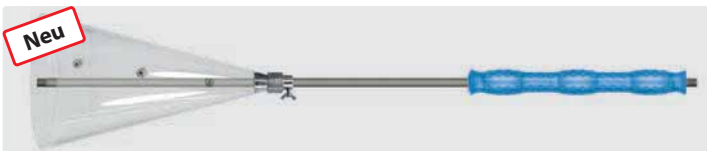
Strahlrohr mit Isolierung ST-29 Cool & Compact. Angenehm ergonomisch geformter Griff. Geschlossene Oberfläche. Mit Spritzschutztrichter, einstellbar mit Flügelschraube. Max. 400 bar / 80 °C
