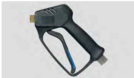
Professionelle Pistole. Weepausführung. Max. 210 bar / 25 l/min / 150 °C
