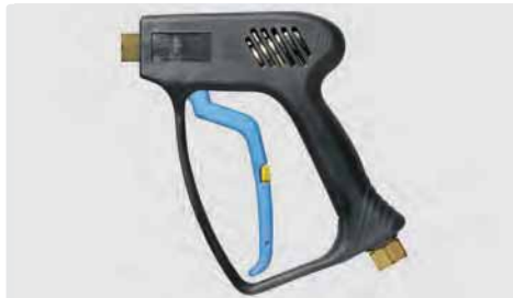
Professionelle Pistole. Weepausführung. Max. 275 bar / 45 l/min / 150 °C
