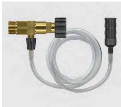
Injektor mit Dosierung, Saugschlauch 1.000 mm und Ansaugfilter ST-31. Max. 220 bar / 90 °C
