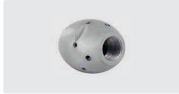
3/8" IG. 6x 75° 3x 30° +1x 0°. 30-100 l/min. Für \text{R} \text{D} 100-200 mm. Außen \text{D} 35 mm. \text{G} 314 g.
