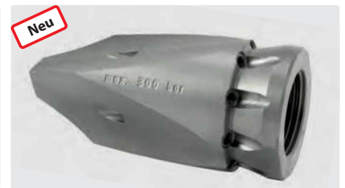
300 bar. 1" IG. Für Rohre > 100 mm. Seitliche Frontstrahlen mit gehärteten Edelstahl Düseneinsätzen.
