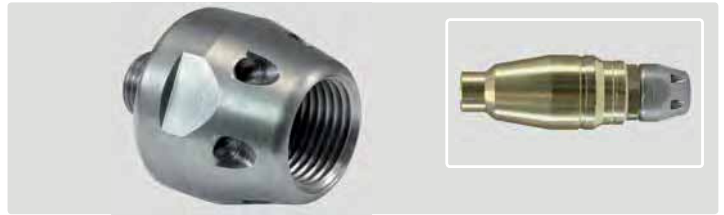
Für Rotordüsen ST-458/ST-559. Gehärteter Edelstahl. Max. 500 bar. ☉ 1/4" AG und 6 M5 Gewindebohrungen für Düsenensätze.
