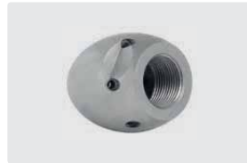
1/2" IG. 6x 75° +1x 0°. 30-100 l/min. Für \text{R} \text{D} 100-200 mm. Außen \text{D} 40 mm. \text{G} 281 g.
