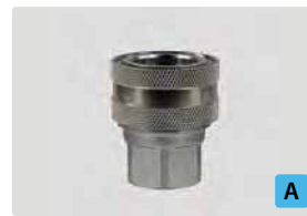
Kupplung : IG. Messing vernickelt. Max. 250 bar / 150 °C
