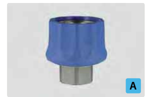
Kupplung : IG. Messing vernickelt. Max. 250 bar / 150 °C
