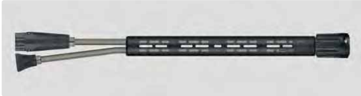
Schaumdoppellanze mit Isolierung ST-9 380 mm, Umschaltventil ST-58, Düsenschutz ST-10 ohne Düse und Schaumkopf ST-75 ohne Düse. Es wird ein Schauminjektor benötigt. Max. 350 bar / 45 l/min / 100 °C
