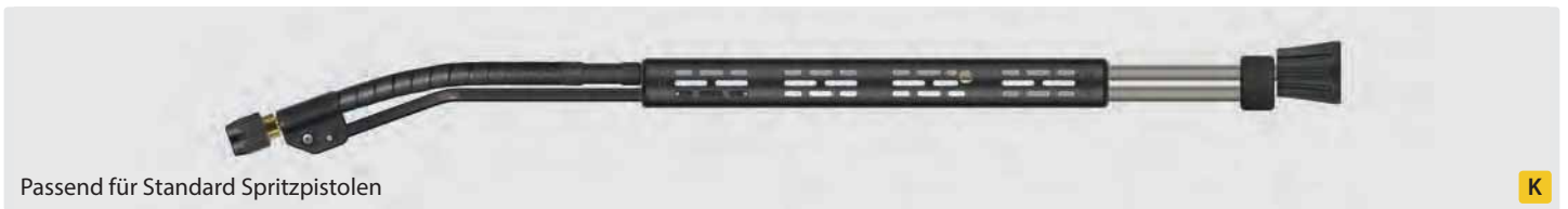
HV M22 drehbar. ST-85 Push & Pull Lanze mit ergonomischer Drehverschraubung passend für Standard Spritzpistolen. Max. 210 bar / 150 °C
