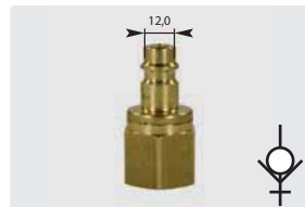
Stecknippel : IG. \varnothing 12 mm. Messing. Mit Ventil. Max. 35 bar / 100 °C
