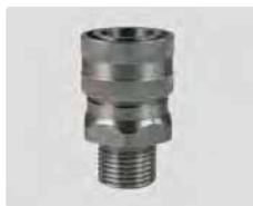
Kupplung : AG. Edelstahl. 60° Dichtkonus. Max. 250 bar / 150 °C
