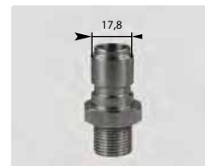
Stecknippel : AG. Edelstahl. 60° Dichtkonus. Max. 250 bar / 150 °C
