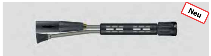
Schaumdoppellanze mit Isolierung ST-9 205 mm, Umschaltventil ST-58, Düsenschutz ST-10 ohne Düse und Schaumkopf ST-75.1 ohne Düse.
