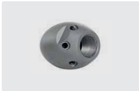
1/4" IG. 6x 75° +1x 0°. 20-50 l/min. Für \text{R} \text{D} 50-100 mm. Außen \text{D} 30 mm. \text{G} 127 g.
