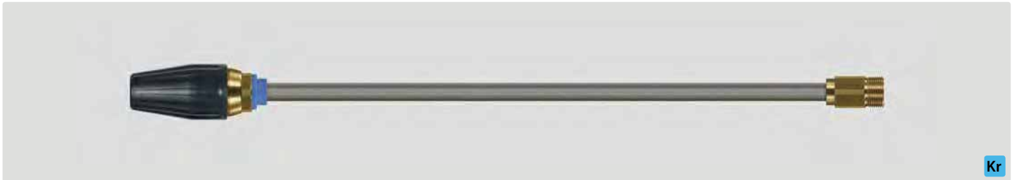
M22 AG. Strahlrohr mit Rotordüse ST-357.1. Spritzwinkel 20°. 100 - 250 bar. Max. 100 °C
