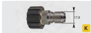
Stecknippel : IG. Edelstahl + Messing. Max. 250 bar / 150 °C
