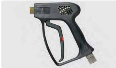
Professionelle Pistole. Max. 275 bar / 45 l/min / 150 °C
