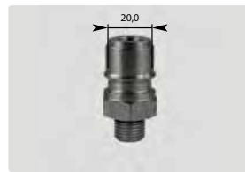
Stecknippel : AG. Edelstahl gehärtet. Max. 250 bar / 150 °C
