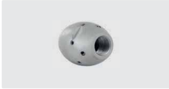
1/4" IG. 6x 75° 3x 30° +1x 0°. 25-70 l/min. Für \text{R} \text{D} 75-150 mm. Außen \text{D} 30 mm. \text{G} 223 g.
