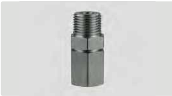
1/2" AG : 1/2" IG. Edelstahl. Max. 350 bar / 90 °C
