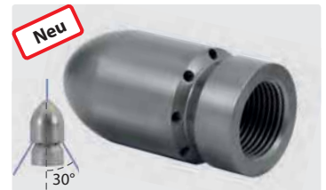
1" IG. Außen \varnothing 48 mm. 8 Bohrungen hinten, 1 Bohrung vorn
