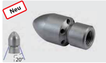
1/4" IG. Außen \varnothing 25 mm. 6 Bohrungen hinten
