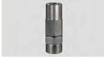
1/4" IG : M22 AG. Edelstahl. Drehgelenk mit Radialgleitlager. Max. 350 bar / 90 °C
