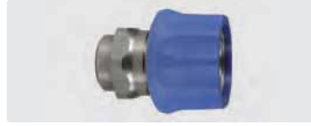
Kupplung : IG. Edelstahl. Max. 250 bar / 150 °C
