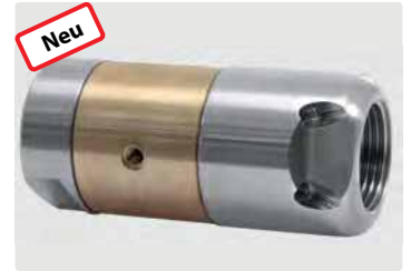
3/4" IG. 6 Bohrungen hinten. 3 Bohrungen seitlich. Außen \varnothing 38 mm. \boxtimes 554 g.
