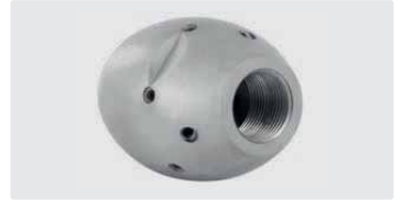
3/4" IG. 6x 75° 3x 30° +1x 0°. 100-250 l/min. Für \text{R} \text{D} 150-300 mm. Außen \text{D} 50 mm. \text{G} 1.367 g.
