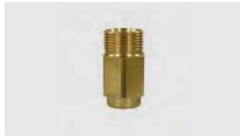
M22 AG : IG. Langbohrung. Max. 400 bar / 150 °C
