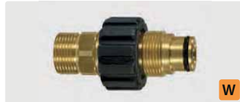
M24 AG : AG. Messing *. Max. 400 bar
