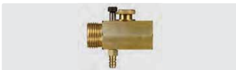
Injektor mit zu- und abschaltbarer Chemiedosierung. Zur Ansaugung von Chemie im Wassereingang der Pumpe. Chemie/Wassergemisch kann somit im Hochdruckbetrieb aufgetragen werden. Rückflussverhinderer (R+M Nr. 734 10) verwenden. Tülle 6 mm. Max. 10 bar / 90 °C
