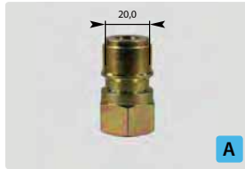
Stecknippel : IG. Stahl verzinkt. Max. 250 bar / 150 °C
