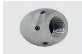
3/4" IG. 6x 75° +1x 0°. 30-100 l/min. Für \text{R} \text{D} 120-250 mm. Außen \text{D} 50 mm. \text{G} 567 g.
