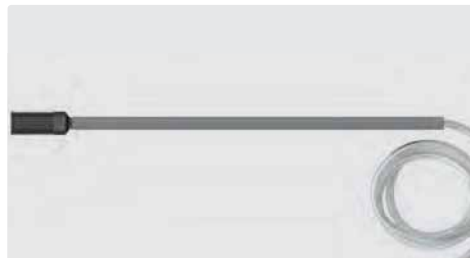
Ansaugset mit Saugschlauch 1.500 mm, Ansaugfilter ST-31 und chemikalienbeständiges Kunststoffrohr 320 mm. Das Rohr hält den Ansaugfilter an der tiefstmöglichen Position.
