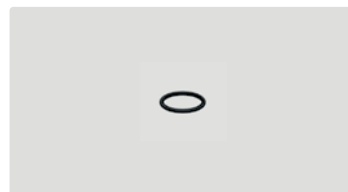
O-Ring. TYP SP-20. 13,1x2,6. Max. 150 bar / 100 °C
