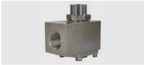
3/4" IG : 3/4" AG. DN 19. Gehäuse und Achse Edelstahl. Max. 200 bar / 90 °C
