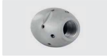
1/2" IG. 6x 75° 3x 30° +1x 0°. 80-140 l/min. Für \text{R} \text{D} 120-250 mm. Außen \text{D} 40 mm. \text{G} 630 g.
