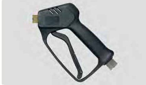
Professionelle Pistole. Max. 210 bar / 25 l/min / 150 °C
