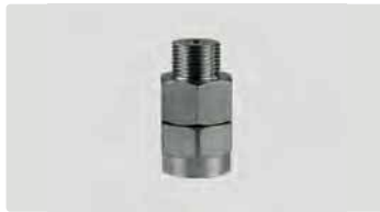
3/8" AG : 3/8" IG. Edelstahl. Max. 500 bar / 90 °C
