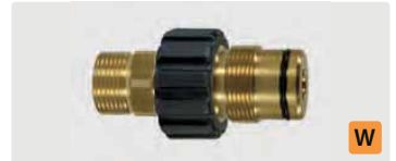
M27 AG : AG. Messing *. Max. 400 bar
