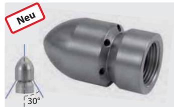
3/4" IG. Außen \varnothing 38 mm. 6 Bohrungen hinten, 1 Bohrung vorn
