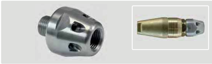
Für Rotordüsen ST-357/ST-456. Gehärteter Edelstahl. Max. 350 bar. ☉ 1/4" AG und 6 M5 Gewindebohrungen für Düsenensätze.
