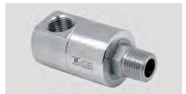
DGEI 90°. Gehäuse Edelstahl. 3-fach gelagert. Max. 350 bar
