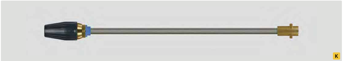
Stecknippel K. Strahlrohr mit Rotordüse ST-357.1. Spritzwinkel 20°. 100 - 250 bar. Max. 100 °C
