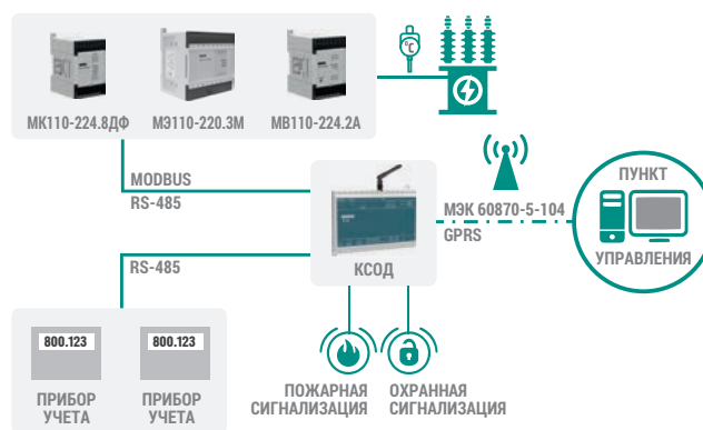
Система телемеханики трансформаторной подстанции 6(10)/0,4 кВ
