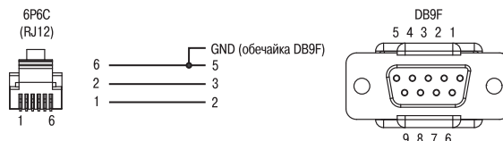
Кабель КС2 для подключения ПЛК (порт RS-232 Debug) к панелям ИП320, СП270 и СП3хх
