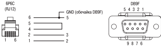
Кабель KC1 для программирования (порт RS-232 DEBUG), входит в комплект поставки
