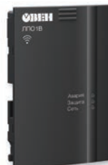
ЛПО1В (с точкой доступа Wi-Fi для ПЧВ1/ПЧВ2)
