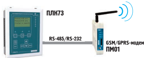
Подключение внешних устройств (например, GSM-модема) в режиме CSD/SMS
