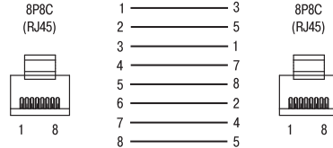
Кабель для соединения ПЛК с компьютером по сети Ethernet напрямую
