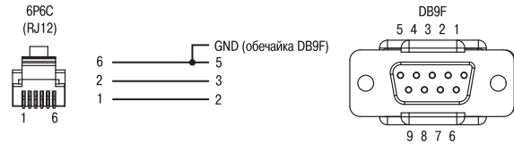
Кабель KC2 для соединения ПЛК (порты RS-232 DEBUG, RS-232) с панелями оператора ИП320, СП270, СП3хх.
