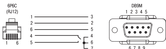
Кабель КС3 для соединения ПЛК (порт RS-232 Debug) с модемом ПМ01[М02]
