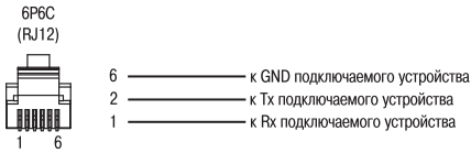
Кабель для подключения ПЛК63 к порту RS-232
