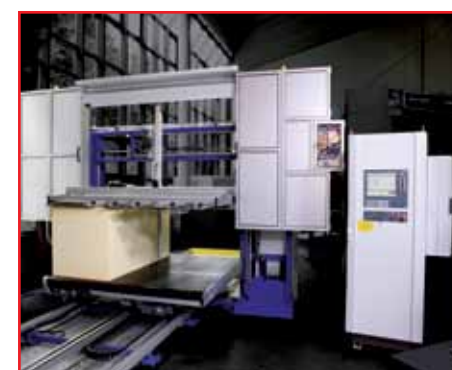
илл.: Горизонтальный станок для контурной резки OFS-HE 3
