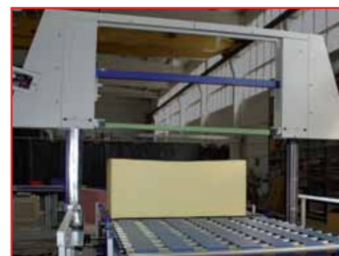
илл.: Обрезной станок ABLG II с замером длины
