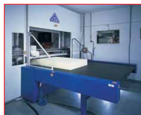
илл.: Вертикальный станок для контурной резки OFS-VT
