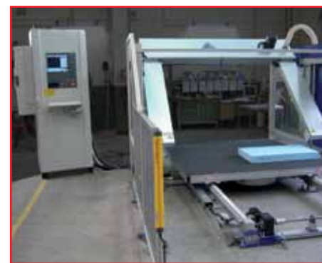
илл.: Горизонтальный станок для контурной резки HFS 2000
