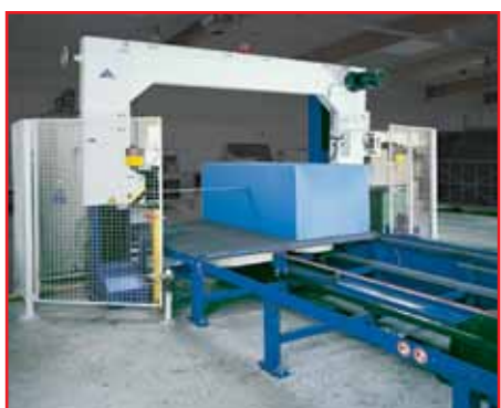
илл.: Горизонтальный резальный станок BSL 204
