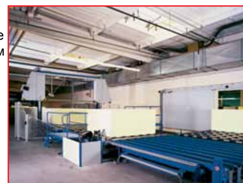
илл.: Весы и маркировочное устройство
