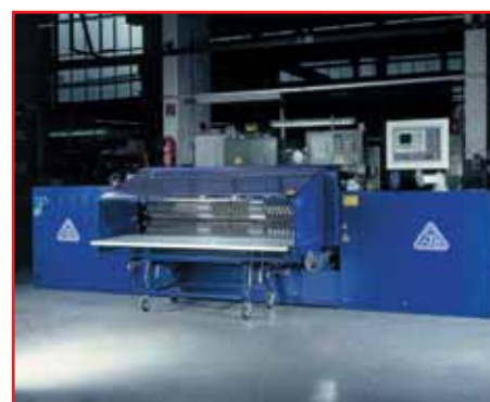
илл.: Профилировочный станок EP
