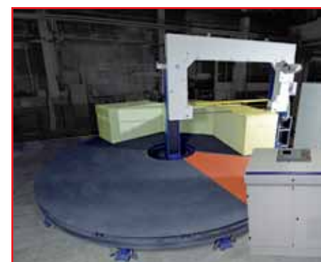
илл.: Горизонтальный резальный станок BSL-D
