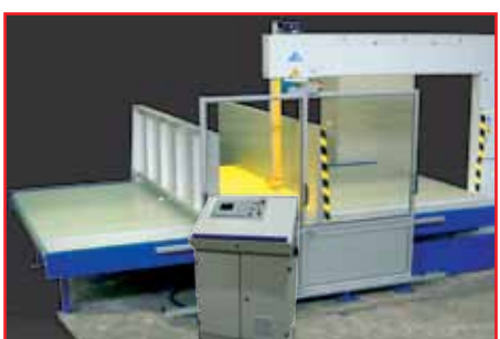
илл.: Вертикальный резальный станок IS-M
