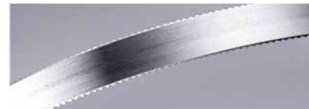
K18 | 12 Teeth/inch; 6-15 x 0,45 mm oder 8 x 0,60 mm
