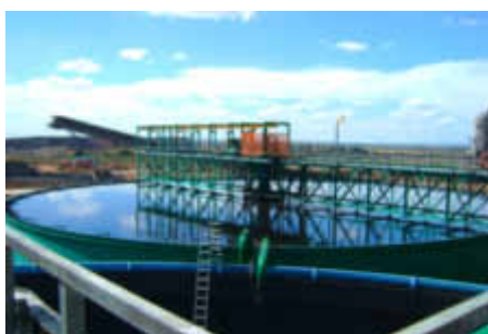
Сгуститель для сгущения хвостов углебогатительной фабрики
