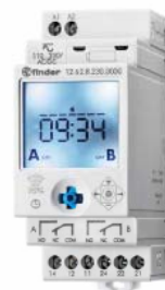
тип 12.62.8.230.0000 Выходные контакты 2 CO (DPDT) 16 A
