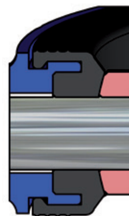
Детальный вид Гнездо седла в корпусе
