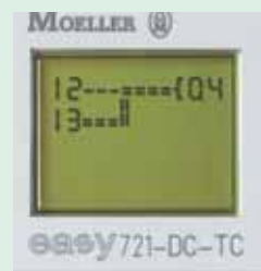
Подсветка схемы соединения в режиме выполнения программы указывает на логическое состояние элементов ==элемент активен
