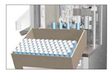
Конструкция машины NM 250 позволяет оператору легко и удобно устанавливать тубы на конвейер.
