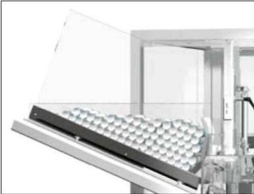
*Полуавтоматическая подача туб с небольшим бункером и моторизованным устройством перемешивания туб.*
