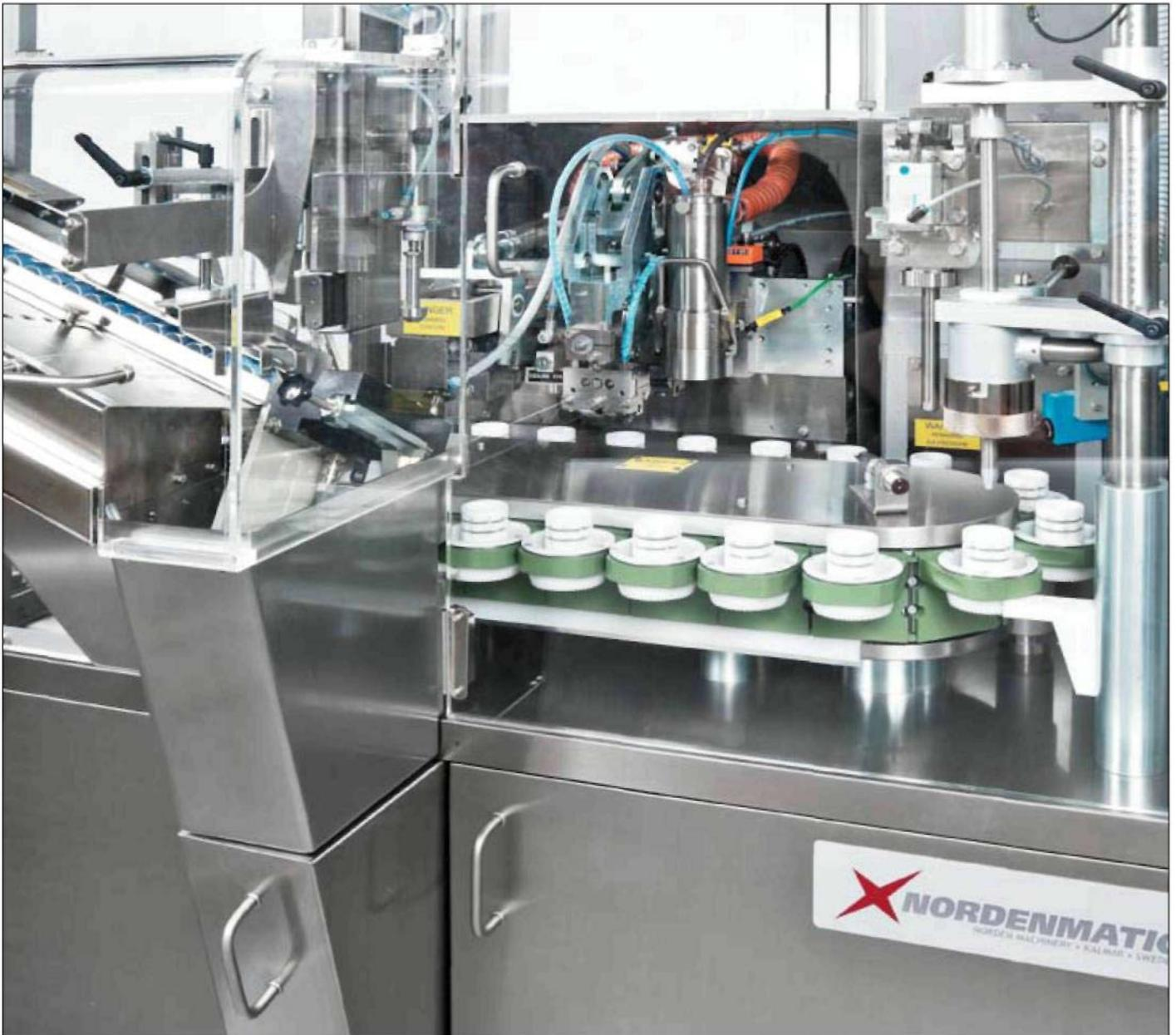
Рабочий стол машины, крышки и дверцы изготовлены из нержавеющей стали.
