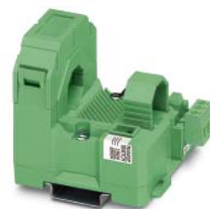
Для синусоидальных и несинусоидальных переменных токов в диапазоне 0...200 А, с выходом напряжения (...-U), с токовым выходом, шлейфовое питание (...-I-LP)
