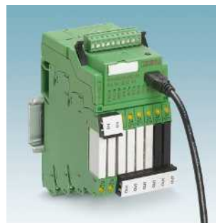
Программируемая система логических реле – PLC logic
