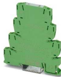
Модуль полупроводникового реле для удлинения входных импульсов, выход пост. тона макс. 100 мА
