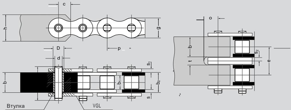
Прочность материала крепежных деталей должна составлять не менее 490 Н/мм<sup>2</sup>. При динамической нагрузке мы рекомендуем оснащать крепежный элемент втулкой. Твердость её поверхности достигает прилб. 60 HRC, что значительно повышает устойчивость к износу. Если нагрузка в основном будет статичная, то устанавливать закаленную втулку не требуется.
