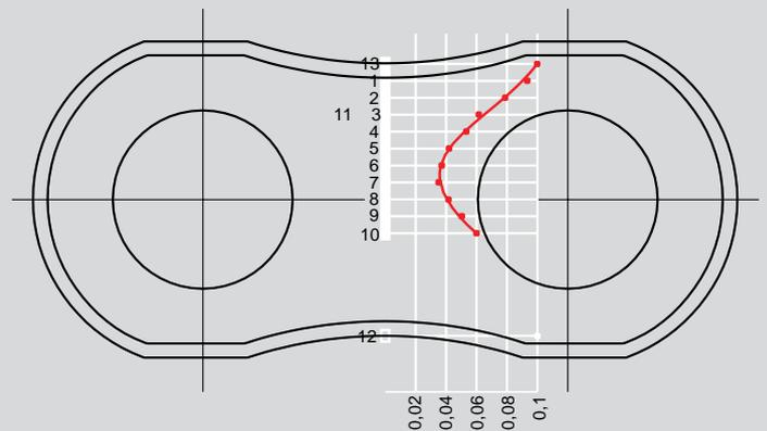
Измерение напряжения внутренней пластины при помощи измерительной полоски.
