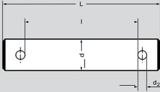
Каждый палец оснащен двумя шплинтами и, начиная с BL 1234 или F 38, дополнительно двумя шайбами.
