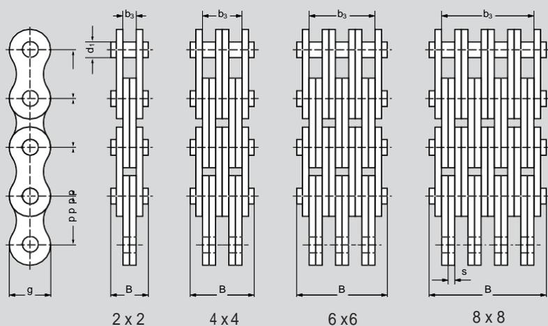
Пластинчатые цепи согласно ISO 4347 / DIN 8152, американская конструкция, тяжелая серия
