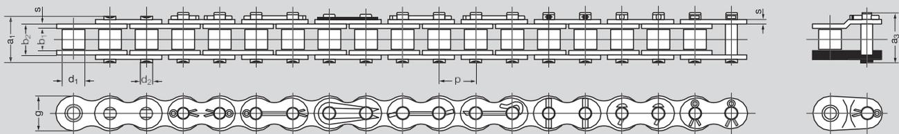
Внутреннее звено    Наружное звено    Наружное звено    Наружное звено    Соединительное звено со штифтом с тавровой головкой    Наружное звено    Соединительное звено со шплинтом    Изогнутое звено со шплинтом
