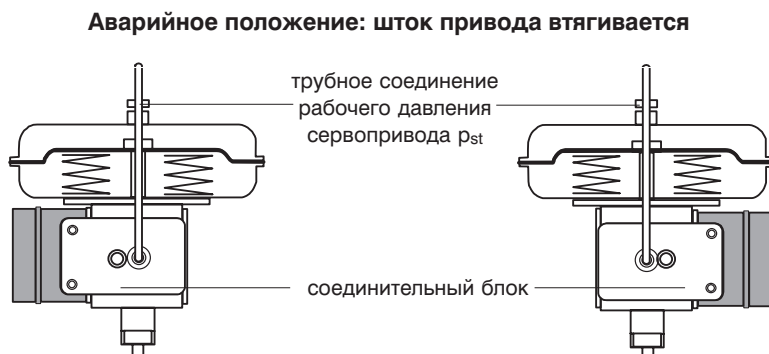
Рис. 10.3 · направление воздействия << монтаж слева
