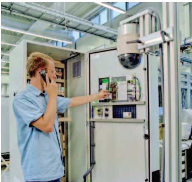
Электрошкаф с SINAMICS S120 книжного формата
