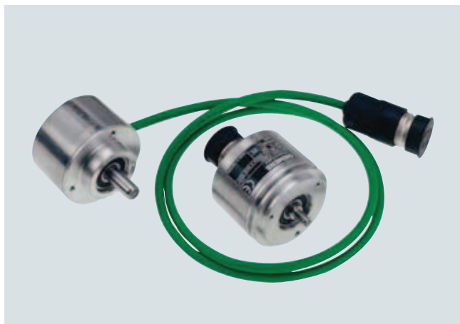
Инкрементальный датчик (sin/cos 1 V pp /RS422/HTL) с кабелем и штекером, зажимным фланцем или синхрофланцем
