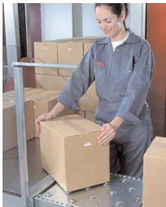
Роликовый конвейер подаёт коробки на подготовительную платформу.
