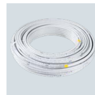
Труба Upronor Comfort Pipe PE-Xa – труба из сшитого полиэтилена PE-Xa с диффузионным барьером от проникновения кислорода EVOH. Цвет белый, с синей полосой. Непроницаемость для кислорода в соответствии с DIN 4726.
