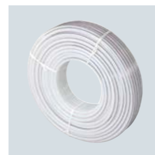
Труба Upronor Comfort Pipe PE-Xa – труба из сшитого полиэтилена PE-Xa с диффузионным барьером от проникновения кислорода EVOH. Цвет белый, с синей полосой. Непроницаемость для кислорода в соответствии с DIN 4726.
