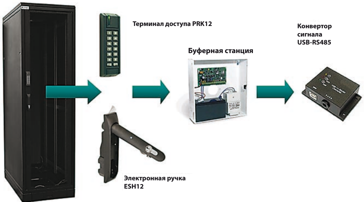
Примерная конфигурация системы доступа к серверным шкафам с использованием буферного центра и конвертора сигнала
