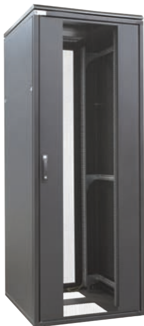
Шкаф SZB SE 42U, 600x1000 мм, цвет RAL 9005, регулировочные ножки, двери с перфорацией типа С, две пары монтажных профилей на расстоянии 19" номер по кат. WZ-SZBSE-003-5711-11-0000-2-161
