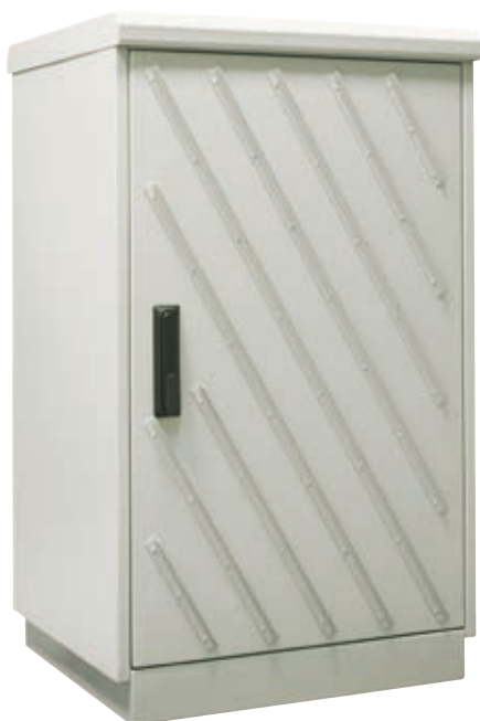
Шкаф с однослойными стенками, целиком изготовлен из листовой стали алюминк, окрашен порошковой эмалью. Двери оборудованы угловыми профилями, утрудняющими наклейку рекламных материалов.
