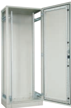
Шкаф шириной 800 мм с монтажными профилями на расстоянии 19", без боковых стенок
