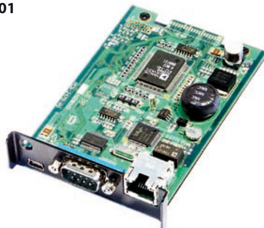
Модуль консоли KVM 1+1 с портом IP
