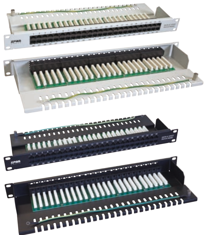
Телефонная патч-панель UTP 19" x 1 U кат. 3, 50 портов RJ45 8P6C серая - № по кат. T-SO-807-138 черная - № по кат. T-SO-807-158
