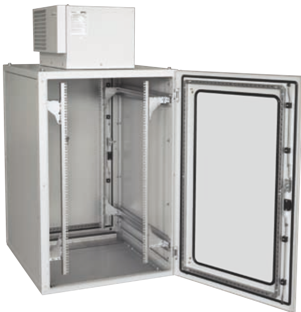
Шкаф SZE2 с кондиционером и 19" монтажные профилями высотой 24U (кондиционеры - см. стр. 313)
