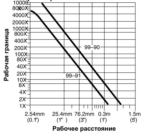
Переданный луч для волокон с диаметром 1 (0,040) с расширенными линзами 63-118
