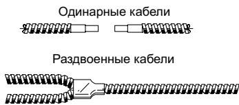
Рис. 14 Волоконные оптические кабели
