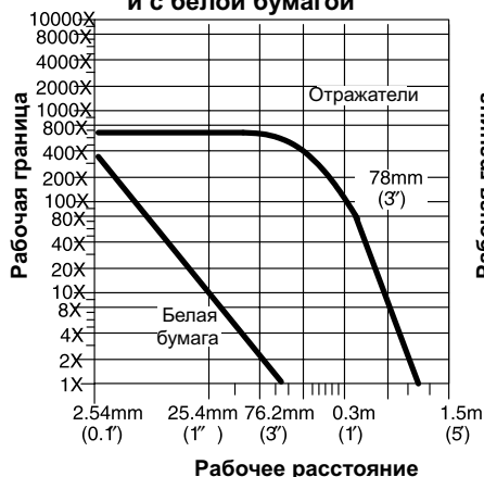
Отраженный луч для волокон с диаметром 1,5 (0,06) с отражателями и с белой бумагой
